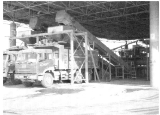
图 3 污泥石灰干化及装车
