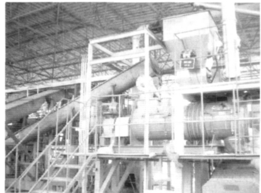
图 4 污泥石灰干化工艺中的混合反应器
